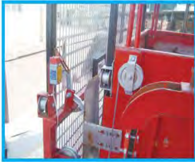
围栏门机电联锁示例
