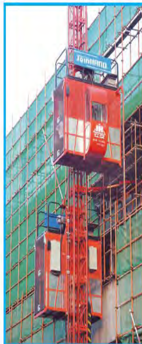
图 SCD 型施工升降机示例
