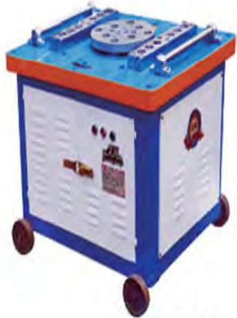
钢筋弯曲机示例
