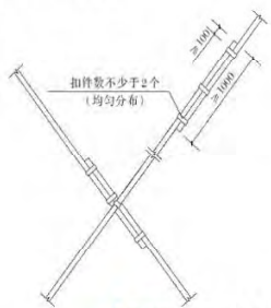
剪刀撑节点大样示意图
