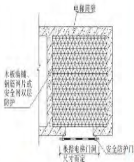
电梯井水平防护平面示意图
